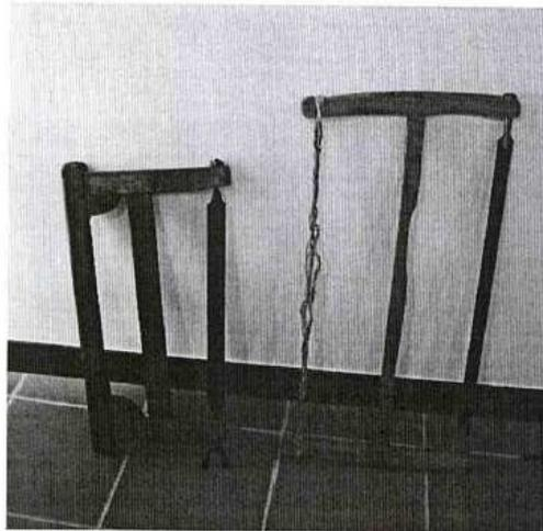
Sierras de carpintero de madera y metal. La de la izquierda tiene una palometa para tensionar la hoja. La de la derecha tiene una cuerda de esparto para el mismo fin.
